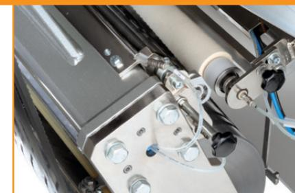
Unidad de lubricación superior (adicional): para panes muy densos o con más de un 40% de contenido en centeno.
